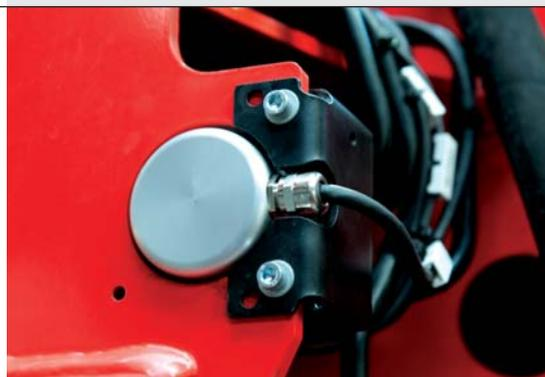
Les stabilisateurs supplémentaires sont également équipés de capteurs de déplacement proportionnels et intégrés au HPSC, donnant ainsi le jour à un système global efficace.
