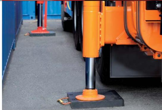
Différentes options existent pour des constructions spéciales ou des cas de figure individuels. Il est par exemple possible d'intégrer du lest ou bien de surveiller les stabilisations avant.
